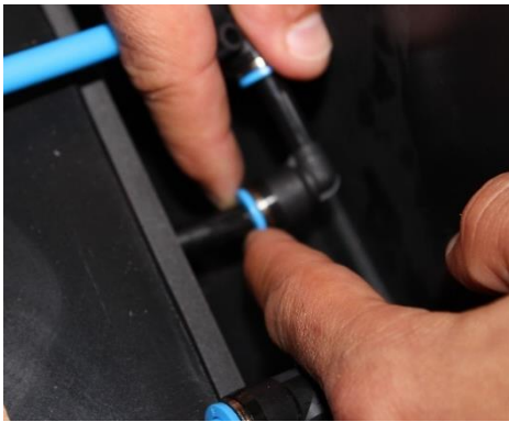
Durch Drücken gegen den blauen Ring der Schnellkupplung wird die Verbindung zwischen der Pumpenzuleitung und dem BD PILLOW VAC III getrennt.
