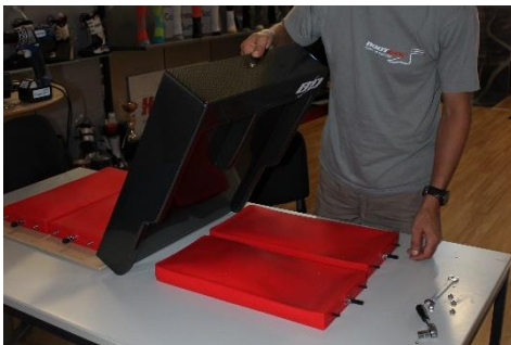
Wenn die Verbindung gelöst worden ist und alle Schrauben entfernt worden sind, ist es möglich die Kissen zu entfernen.
